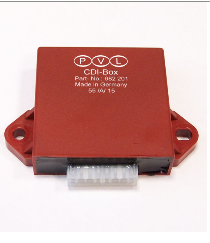
PHOTO DU BOITIER ELECTRONIQUE PHOTO OF THE E.C.U.
